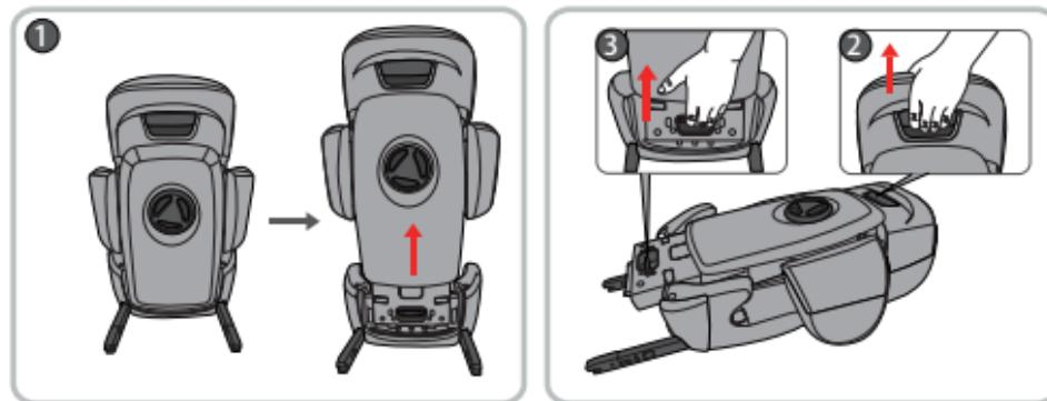
**SIÈGE AUTO PLIANT :** Appuyez sur le bouton de réglage de l'appui-tête et soulevez l'appui-tête jusqu'à ce que le bouton de pliage soit visible. Appuyez sur le bouton de pliage pour plier le dossier. Tirez l'appui-tête jusqu'à la limite.
