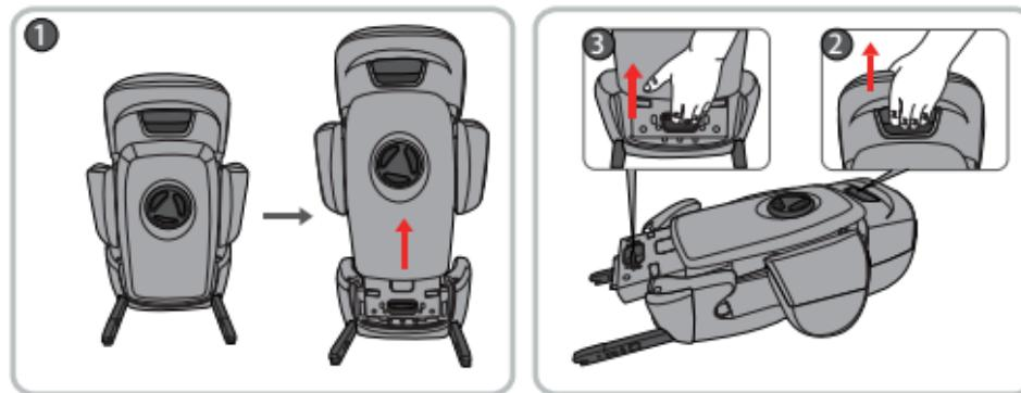
SEGGIOLINO PER AUTO PLEGHEVOLE: aziona il pulsante di regolazione del poggiatesta e solleva il poggiatesta finché il pulsante di chiusura non diventa visibile. Azione il pulsante di chiusura per piegare lo schienale. Tita il poggiatesta fino al limite.
