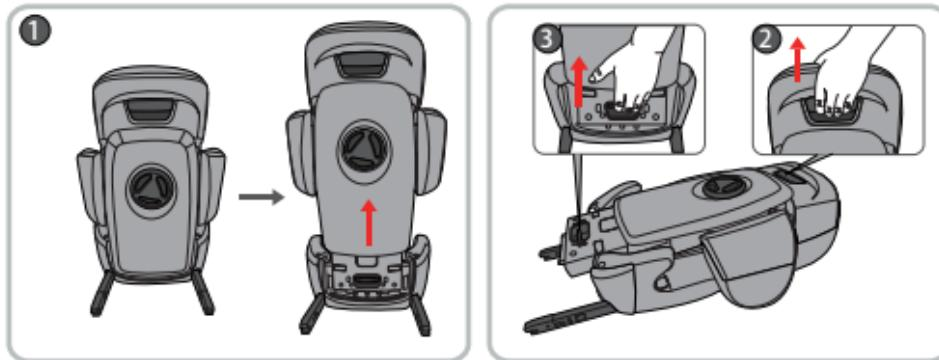
SILLA PLEGABLE DE COCHE: accione el botón de ajuste del reposacabezas y levante el reposacabezas hasta que el botón de plegado quede al descubierto. Accione el botón de plegado para plegar el respaldo. Tire del reposacabezas hasta el límite.
